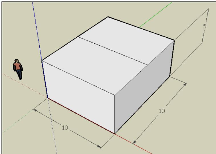
4. Déplacer l'arête du toit vers le haut sur 2 m pour garder la symétrie du toit
